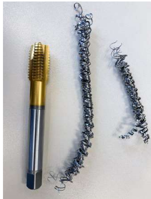
Bei der Bearbeitung von Hardox 500 bildet der Durchgangslöcherbohrer der Familie Rekord von Emuge einen sauberen Zopfspan, der nach unten geschoben wird.
