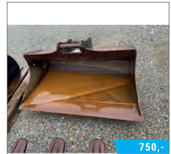
Grabenräumlöffel KL1.0 GR-R150 SI10 für Bagger 5,5-9 t, SI10, Inhalt 0,42 m³, Breite 1500 mm, Gewicht 240 kg gebraucht BJ 2018, SNr. 18/35566
