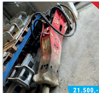
Hydraulikhämmer PROMOVE XP1700 für Bagger 19-28 t, Gewicht 1.700 kg, mit Meißel und Schmiersystem, gebraucht, BJ 2019, SNr. PRO.3219013
