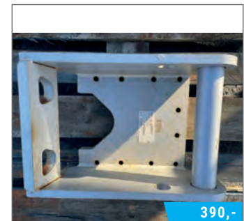
Anbauplatte SW08 LEHNHOFF für Bagger 5-9 t, für VTN MD65, MD100, PD02, PM200 o. Befestigungselemente, leicht gebraucht BJ 2016, SNr. 16/31309
