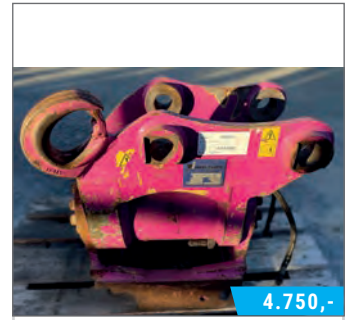
Schnellwechsler snapit! SI11 HPK für Bagger 9-12 t, hydraulisch, mit HKS BVF-L160 2x89°, für TEREX TW110, mit Lasthaken, leicht gebraucht BJ 2018, SNr. 18/35100
