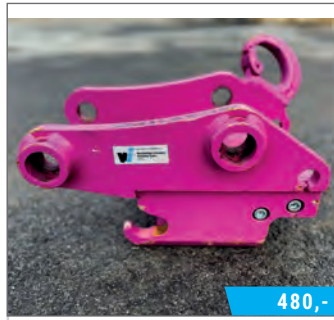
Schnellwechsler snapit! SI03 MS für Bagger 1,8-3,5 t, mechanisch, für JCB 2CX, 3CX COMPACT, mit Lasthaken, leicht gebraucht BJ 2021, SNr. 21/45703
