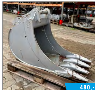
Tieföffel KL1.2 T60 SI11 K15RC für Bagger 9-12 t, SI11, Inhalt 270 l, Breite 600 mm, Zähne KOMATSU, Gewicht 190 kg, leicht gebraucht BJ 2015, SNr. 15/29147
