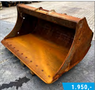
Grabenräumlöffel KL2.8 GRR170 SI18
